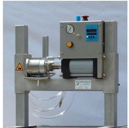
MMP-3 met een pneumatische tijdsvertrager van 0 – 16 minuten.
